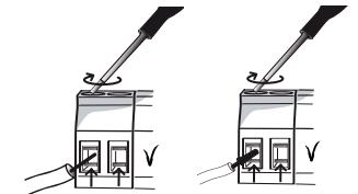
Om du skall ansluta två eller fler ledare i samma kopplingsplint (oavsett ledararea) gör följande: Använd metallisk presshylsa (använd krymp verktyg) till alla 0,5 mm<sup>2</sup> ledare och anslut normalt i kopplingsplinter.
