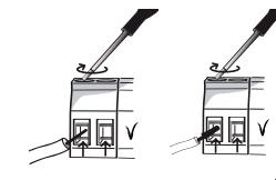
Jos liität vähintään kaksi johdinta samaan liitintään (tyypistä huolimatta), toimi seuraavasti: Kiinnitä metallinen puristin (kayta puristusyokalua) kaikkiin  $0,5 \text{ mm}^2$ :n johtimiin ja kytke johdinta peittävät puristimet liitintään kaikkien muiden johdintyyppien kanssa. Kiinnitä tämän jälkeen normaalisti.
